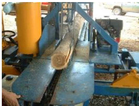
Foto 5.1. Equipo de aserrío de fabricación nacional, con hoja y cadena de motosierra (Precious Woods)
